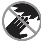
**Kommen Sie mit Ihren Händen nicht in den Sägebereich, während das Elektrowerkzeug läuft.** Beim Kontakt mit dem Sägeblatt besteht Verletzungsgefahr.
