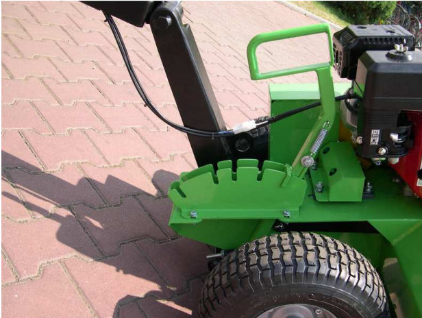
Schalhebel in der Stellung „max. Arbeitstiefe“
