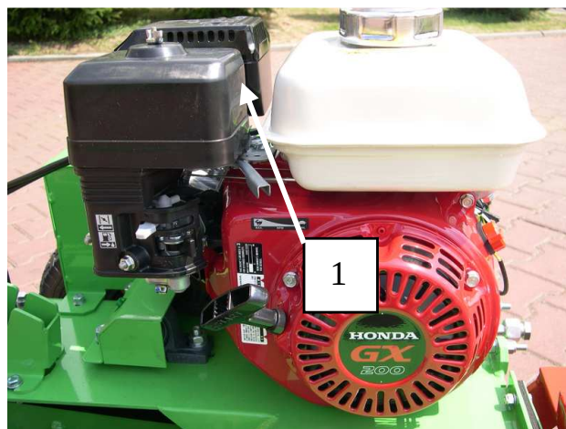
Luftfilter (1), unter Haube
