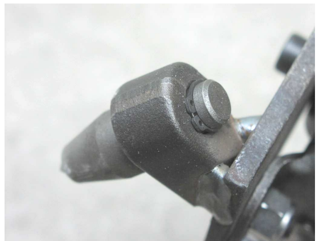
Sicherungsring der Spitze
