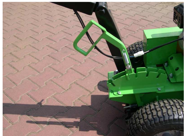
Schalthebel in der Stellung „min. Arbeitstiefe“
