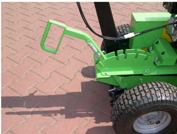
Schalthebel in der Stellung „aufgehoben“
