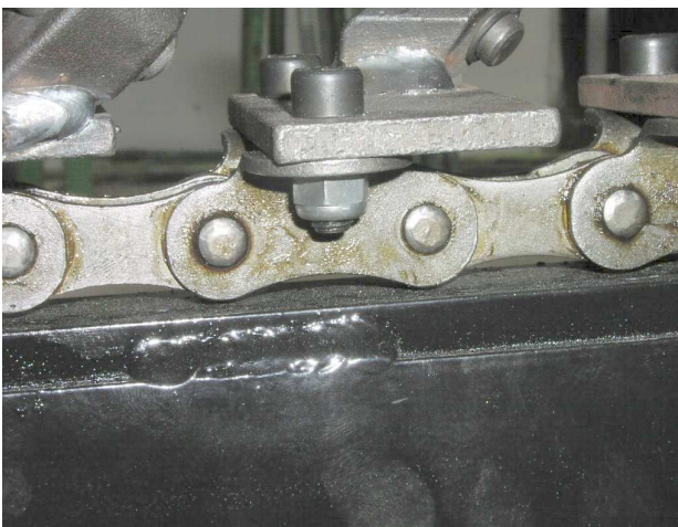
Halterung der Kettenspitzen
