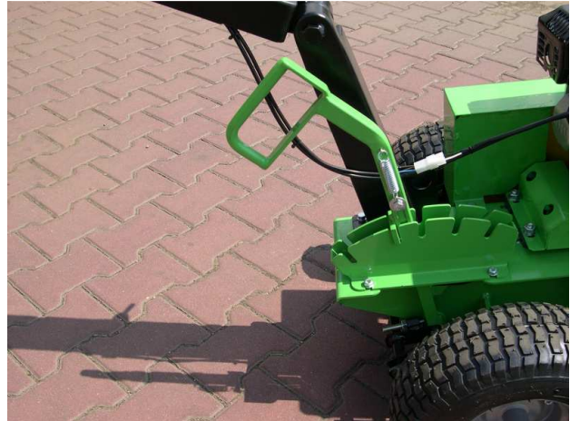
Schalhebel in der Stellung „min. Arbeitstiefe“
