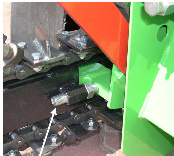
Spannschraube der Arbeitskette
