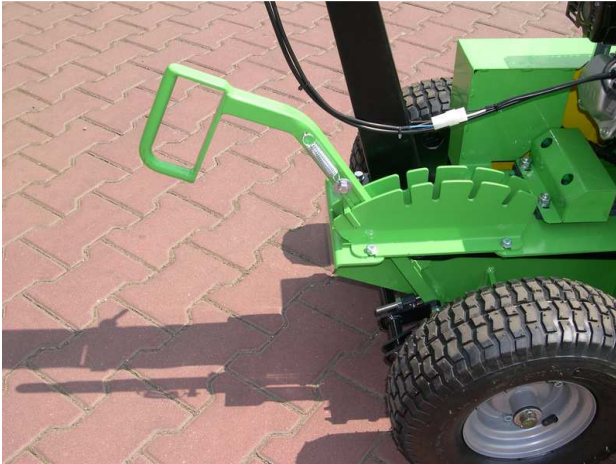
Schalhebel in der Stellung „aufgehoben“
