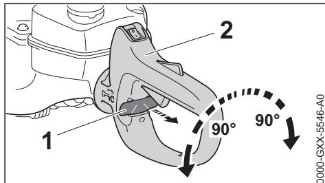
Voor het comfortabel geleiden van de heggenschaar bij alle werktechnieken kan de handgreep 90° links- en rechtsom worden gedraaid.
