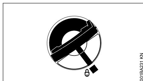
In deze stand staan de markeringen op de tankdop en de benzinetank met elkaar in lijn
