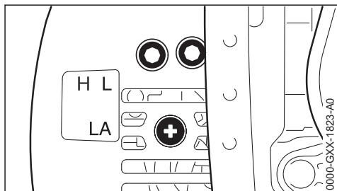
De carburateur is zo afgesteld dat de motor onder alle bedrijfsomstandigheden wordt voor- zien van een optimaal benzine-luchtmengsel.
