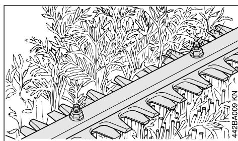
De HS 82 T is geconstrueerd voor het in vorm knippen en trimmen van heggen en struiken met dunne twijgen.
