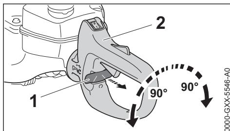
Zur komfortablen Führung der Heckenschere bei allen Arbeitstechniken kann der Handgriff um 90° nach links und rechts gedreht werden.
