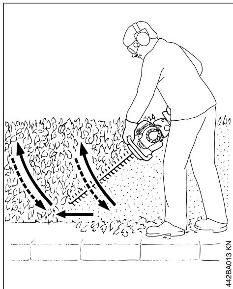
Heckenschere bogenförmig von unten nach oben führen – absenken und weitergehen – und die Heckenschere wieder bogenförmig nach oben führen.
