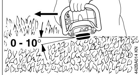
Schneidmesser in einem Winkel von  $0^\circ$  bis  $10^\circ$  ansetzen – aber waagerecht führen.
